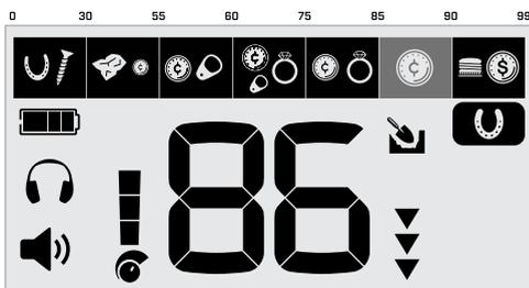
L'ultimo ID Target rilevato rimane sul display per 5 secondi o finché non viene rilevato un altro target.
